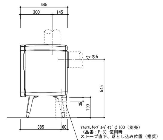
側面図 (外気取入口底面)
