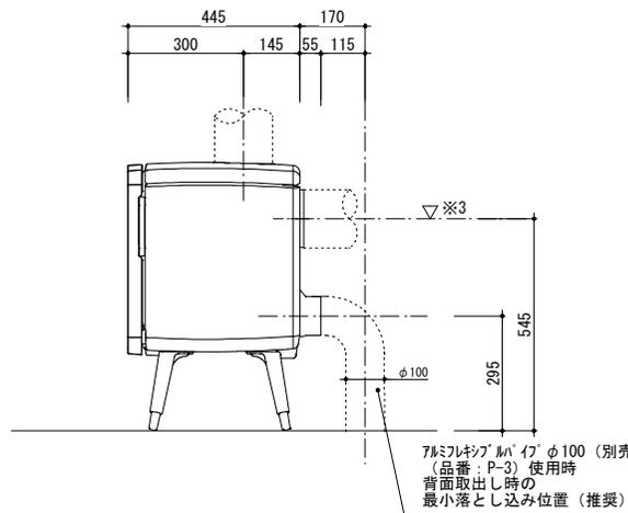
側面図 (外気取入口背面)
