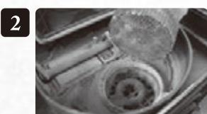
リフラクトリーを取り外し、コンバスターが割れないかチェックします。インテラム・ガスケットの交換の準備もしてからコンバスターを取り外します。
