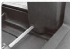
9/16インチのスパンナで六角ボルトを外し、プラス・ドライバーを差し込み回して調整してください。
