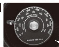
その後ストーブトップのプローブ温度計の温度が220°Cに達していることを確認します。
