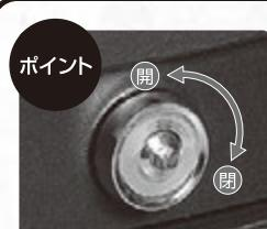
着火時にこのダイヤルを開くと、空気が勢いよく送り込まれ、素早く着火出来ます。安定燃焼しましたら、必ずダイヤルを閉めてください。開いたままにしておくと炉床を傷める原因となります。
