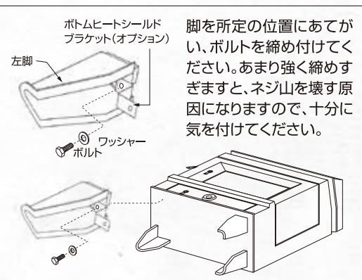
脚を所定の位置にあてがい、ボルトを締め付けてください。あまり強く締めすぎると、ネジ山を壊す原因になりますので、十分に気を付けてください。
