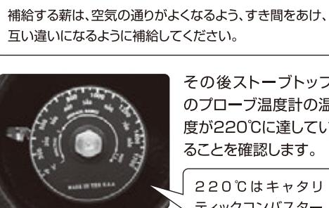
その後ストーブトップのプローブ温度計の温度が220°Cに達していることを確認します。
