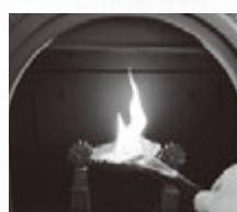
煙突が冷えているとドラフト（上昇気流）が弱く、着火しない、うまく燃えない、煙が室内に逆流してしまうといった問題が起こる場合があります。そんなときは、バイパスダンパー付近に火（着火剤に火を着ける）をかざすことで、煙突が暖まりドラフトが発生します。
