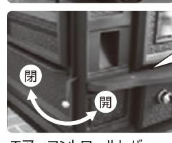
慣らし焚きの際は、ストーブ温度計が200°C以上にならないようエアコントロールレバーで給気を調節してください。
