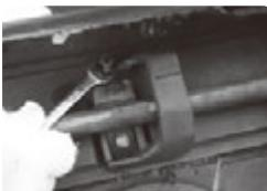
ダンパー調整用ナット、そしてボルトを緩めます。
