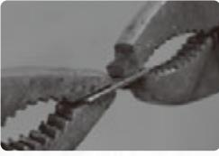
ガラス窓がガタガタしているときは、内側でガラスを押さえている押さえ金具をプラス・ドライバーで外します。板状の金具の両端を2つのペンチで挟み、少し内側に曲げます。
