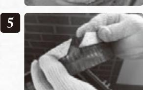
煤が取れたらコンバスターに新しいインテラム・ガスケットを巻いて元に戻します。
