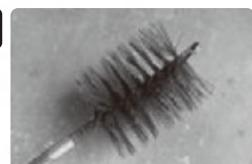
煙突径に適応したブラ
