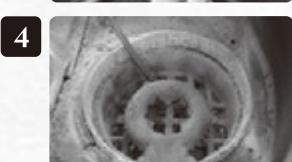
コンバスターの下のアディストリビューターの周りにこびりついている煤をドライバーなどでトントンと叩き、下へ落とします。
