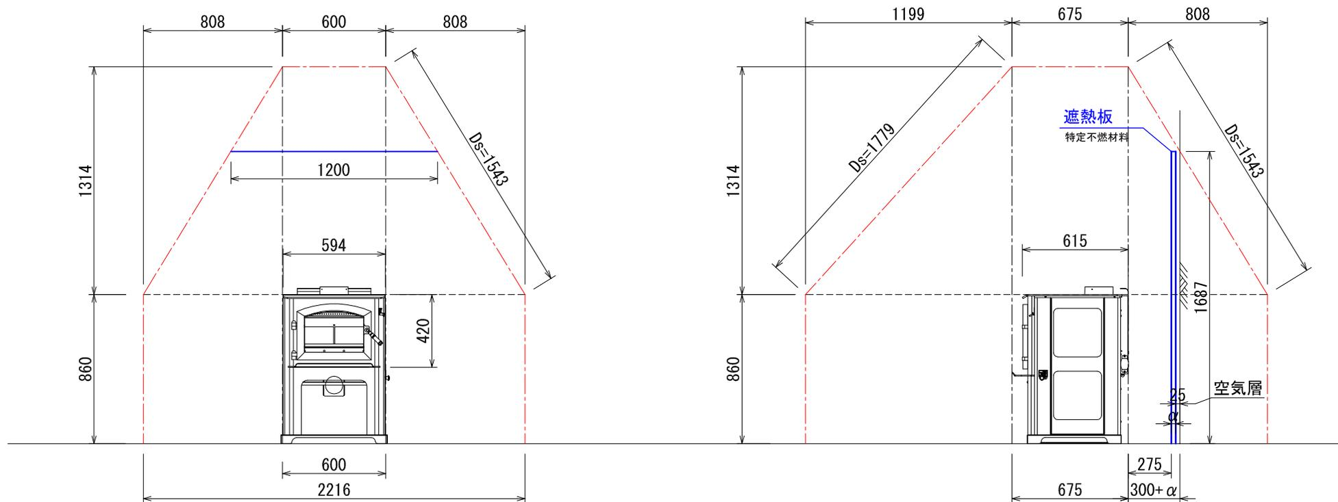
\*:  $\alpha$ は115mm厚以上のレンガ以外の不燃材遮熱壁の厚みを差します。
